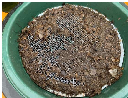
図 28 液肥を濾過した際の固形分
